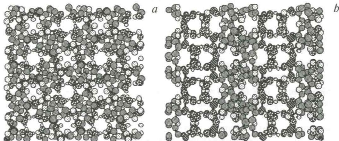
Общий вид кристаллогидрата каликс[4]арен-*para*-сульфокислоты с восемью молекулами воды: вид сверху (а) и сбоку (b).
