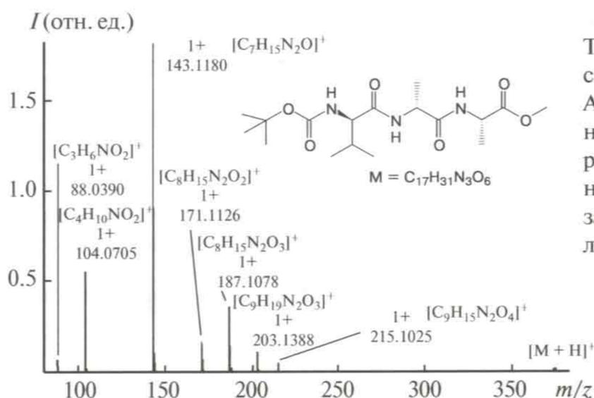
Тандемный масс-спектр Boc-Val-Ala-Ala-OCH<sub>3</sub>, полученный в режиме регистрации положительных ионов при ионизации электрораспылением.
