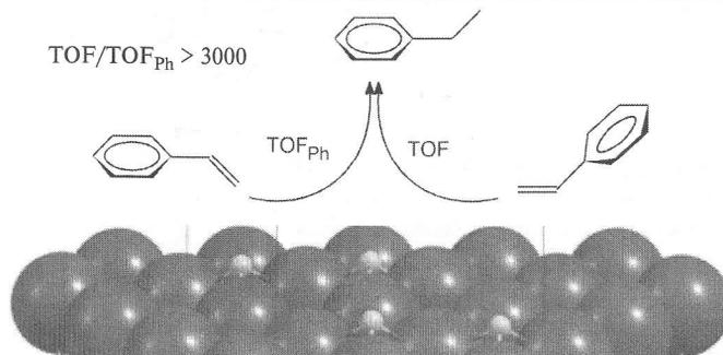
Адсорбция Ph-группы на поверхности Pd{111} существенно снижает скорость гидрирования молекулы стирола в этилбензол (TOF — частота оборотов катализатора).
