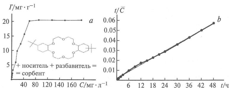
Изотерма адсорбции  $\Gamma = 25.58 \cdot 0.0292C / (1 + 0.0292C)$  (a) и кинетическая кривая сорбции  $t/\bar{C} = 0.0011t + 0.002$  ( $R^2 = 0.9976$ ) (b) стронция.
