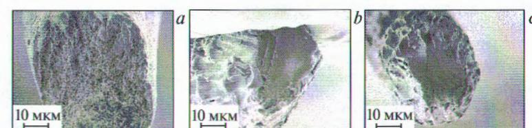
СЭМ-микрофотографии поламиидокислотного волокна: исходного (a); подвергнутого термической обработке при 300 °C в течение 1 ч (b) и подвергнутого химической имидизации (c).
