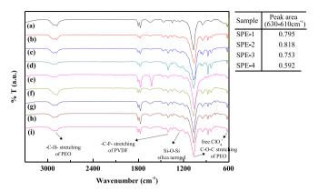
Fig. 3. FT-IR spectra of the solid polymer electrolytes (a) SPE-1, (b) SPE-2, (c) SPE-3, (d) SPE-4, (e) SPE-5, (f) SPE-6, (g) SPE-7, (h) SPE-8, and (i) SPE-9.
